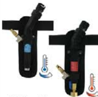
3M™ Versaflo™ V-100E (raffreddatore aria) e V-200E (riscaldatore aria) I sistemi consentono di modificare la temperatura dell'aria compressa di 28°C riportata alla temperatura di alimentazione migliorando così il comfort dell'operatore.
